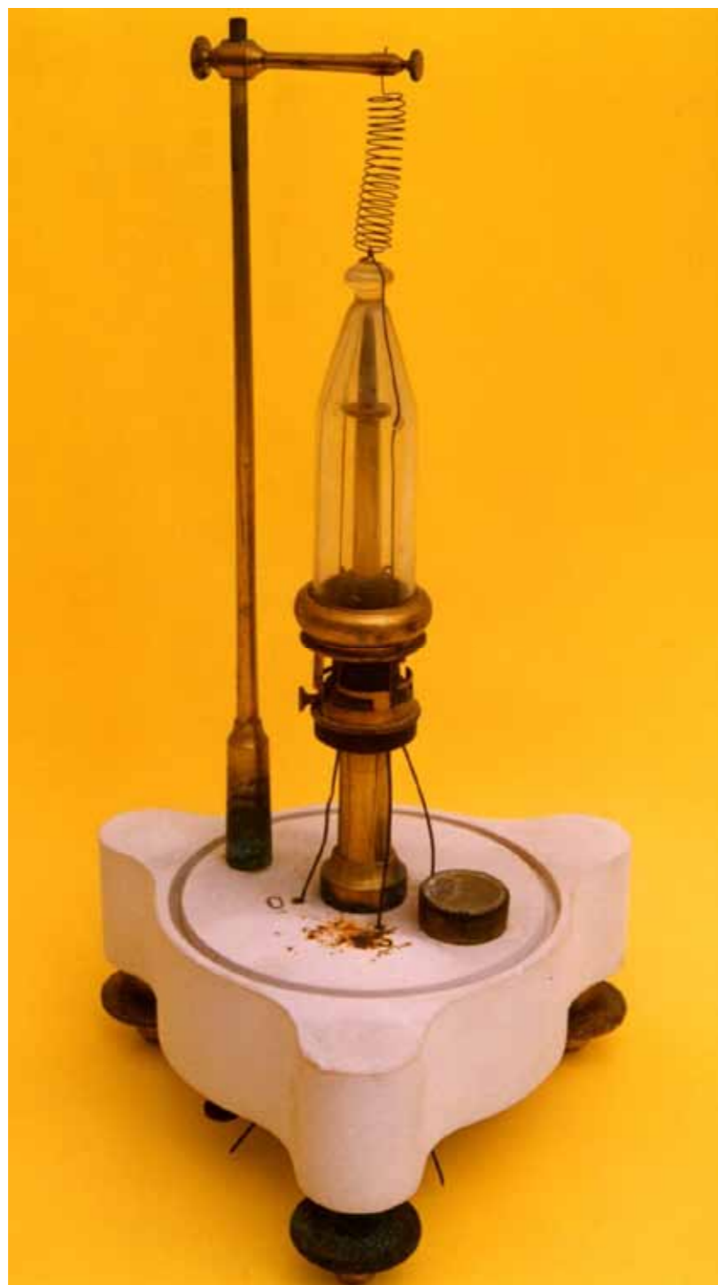
Sismografo registratore Scateni per oscillazioni orizzontali conservato al Museo del Gabinetto di Fisica
